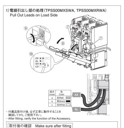
・ラッチが本体に正しく掛かって いることを確認して下さい。 · Please make sure the latch is inserted correctly.
